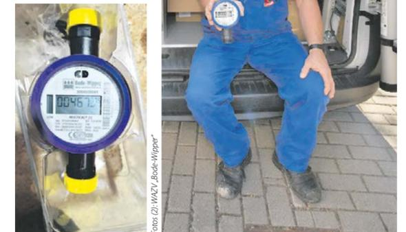
Damit der Trinkwasserverbrauch exakt gemessen wird: Zur Prüfung der Eichfristverlängerung wurden zahlreiche Zähler zum „Check-up“ verschickt.
