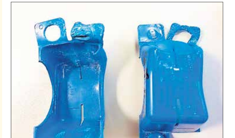
Die manipulierte Plombe eines Wasserzählers aus dem Verbandsgebiet des WAZV „Bode-Wipper“.
