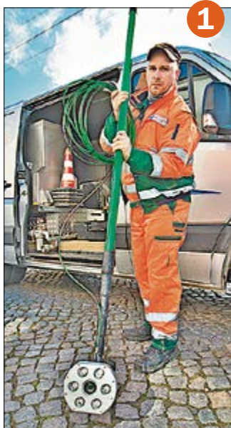
Ein abwechslungsreicher Tag im Leben der Abwasserfachkräfte: Sebastian Wessel zeigt die Kamera, die einen hochauflösenden Blick in den Kanal ermöglicht (1). Stefan Jedlitschka inspiziert den soeben gereinigten Kanal am Monitor (2), um schon kurze Zeit später mit dem Saugwagen des WAZV eine abflusslose Sammelgrube auszupumpen (3). Währenddessen tauschen Dominic Radl (1.) und Marcus Bullin die beschädigte Pumpe eines unterirdischen Pumpwerks aus (4).
