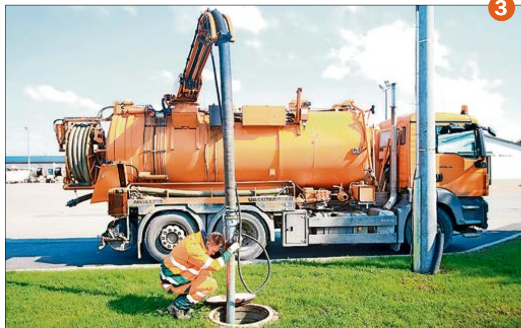
Ein abwechslungsreicher Tag im Leben der Abwasserfachkräfte: Sebastian Wessel zeigt die Kamera, die einen hochauflösenden Blick in den Kanal ermöglicht (1). Stefan Jedlitschka inspiziert den soeben gereinigten Kanal am Monitor (2), um schon kurze Zeit später mit dem Saugwagen des WAZV eine abflusslose Sammelgrube auszupumpen (3). Währenddessen tauschen Dominic Radl (1.) und Marcus Bullin die beschädigte Pumpe eines unterirdischen Pumpwerks aus (4).
