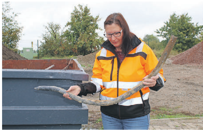
Claudia Jaffke zeigt ein altes Rohr aus Blei. Laut Trinkwasserverordnung müssen diese bis 2026 entfernt werden.
