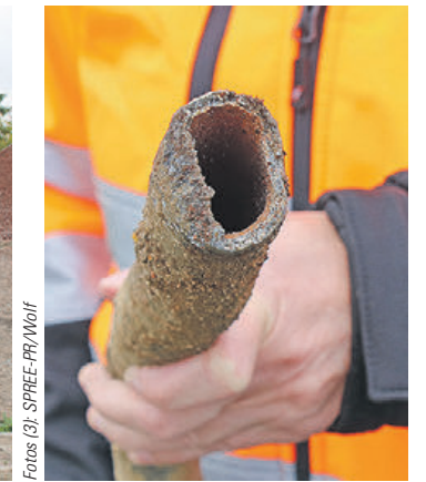
Claudia Jaffke zeigt ein altes Rohr aus Blei. Laut Trinkwasserverordnung müssen diese bis 2026 entfernt werden.
