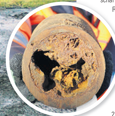
Erfahrung zahlt sich aus! Seit 2013 bekämpft Florian Reitmeier die Wasserverluste beim WAZV, die u.a. durch zugesetzte Rohre entstehen können (kl. Foto rechts) und manchmal kaum zu erkennen sind (gr. Foto oben).
