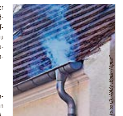
Die Nebelschwaden zeigen deutlich, dass dieser Eigentümer sein Regenwasser ins Kanalnetz einleitet. Wenn er dafür auch Niederschlagswassergebühren entrichtet, ist alles in bester Ordnung.
