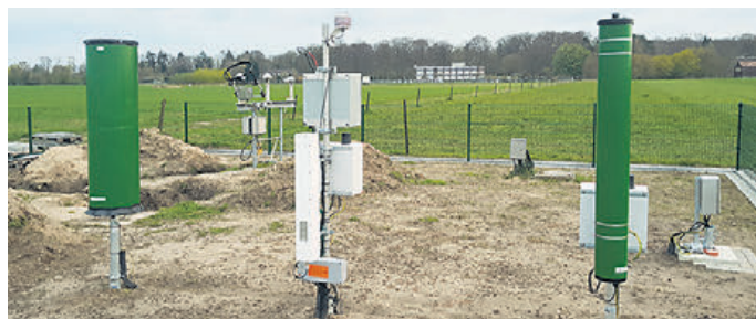
Drei neu installierte „Cosmic-Ray-Neutron-Sensor“-Messsysteme bestimmen die mittlere Bodenfeuchte im Umkreis von mehreren Hektar.
