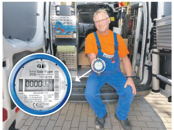
**Volker Stelmecke hält die Zukunft in den Händen. Der elektronische Wasserzähler misst den genauen Wasserverbrauch durch Ultraschall, noch präziser als es ein mechanischer Zähler kann.**
